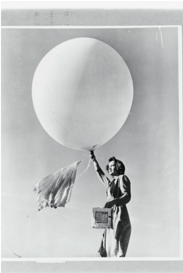
Eine Radiosonde an einem Wetterballon.
